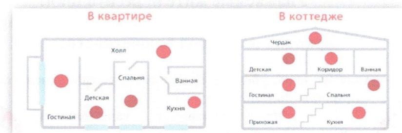
При монтаже расстояние от датчика до осветительного теплоизлучающего прибора должно быть не менее 0,5 м, до вентиляции не менее 1м. Как правило прибор монтируется в центре потолка либо у стены но не ближе 10 см. Если датчик расположен на стене, то расстояние до потолка должно быть 10 – 30 см, вместе с габаритами самого прибора.
